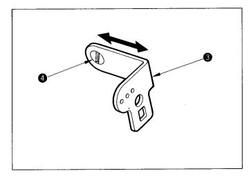
2) エスレン装置セットより、取付板③および止めねじ ④を取り出しアーム中央部のボスへ固定します。
